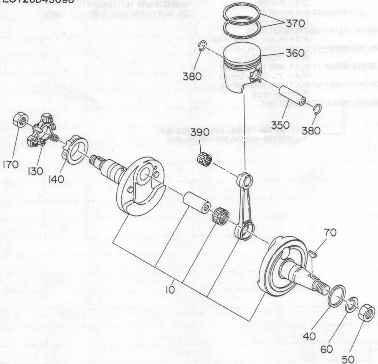
2. クランクシャフト, ピストン・・・CRANKSHAFT, PISTON
