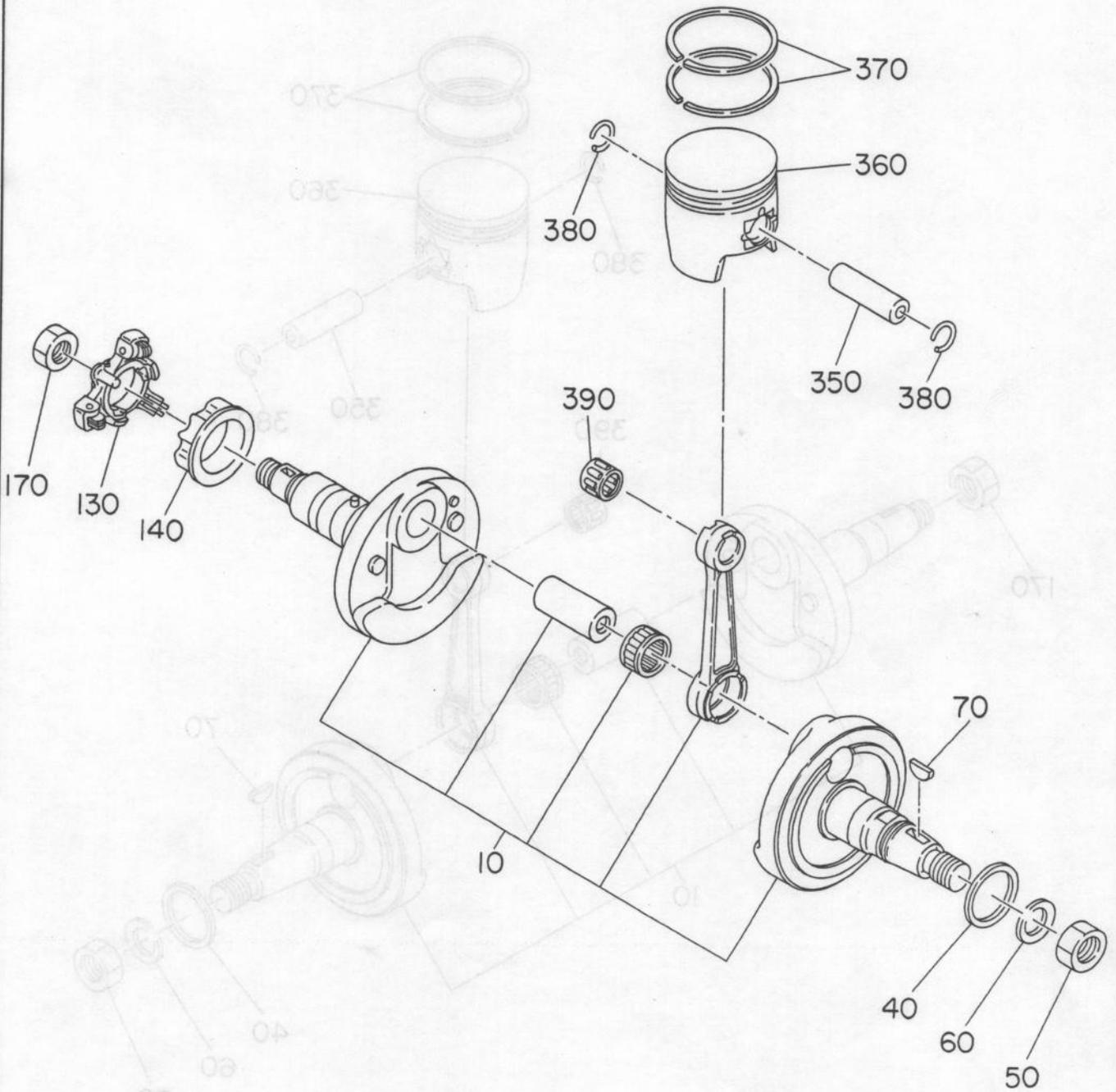
2. クランクシャフト, ピストン・・・CRANKSHAFT, PISTON
