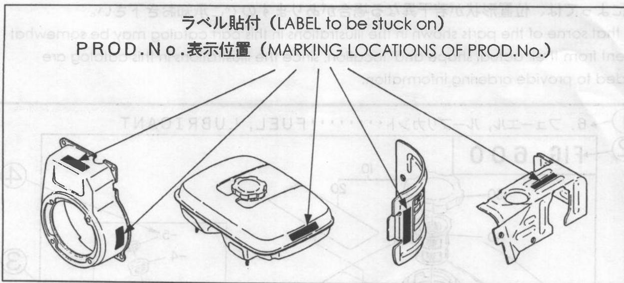
PROD.No. (15桁) のラベルは、ブローハウジング、フューエルタンク、シリンダバッフル、ヘッドカバーのいずれかの見易い位置に貼付してあります。
